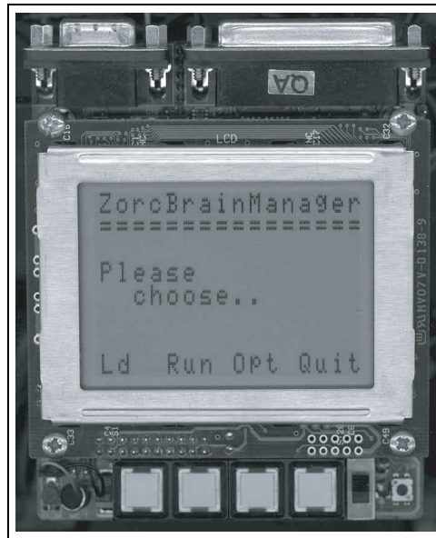
Abbildung 5.2: Das Foto zeigt den EYEBOT-Controller, der das Programm ZORCBRAIN ausführt. Die im LCD sichtbaren Menüpunkte können über die darunter gelegenen Menütaster ausgewählt werden.
